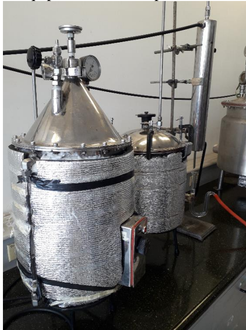
Figura 7: equipo de extracción por arrastre con vapor
