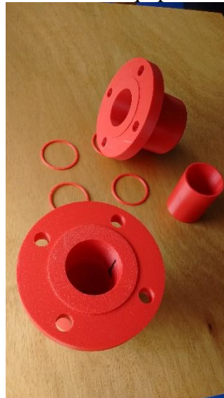
Figura 9: vaso de extracción del equipo de FSC impreso en ABS
