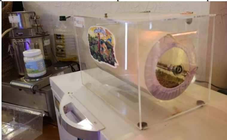
Figura 1: Separador mecánico de tricomas para extracciones a temperatura ambiente.
