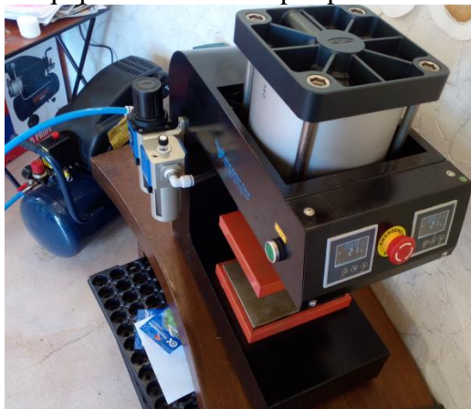
Figura 6: equipo de extracción por prensado en caliente
